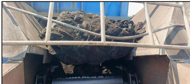
**Gambar 2.** Kondisi Batu yang Menumpuk di *Hopper*
